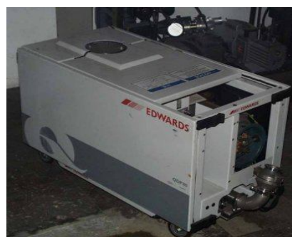
Безмасляный насос Edwards Dry Star QDP80 Производительность: 80 м³/ч
